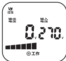
过压：当输出电压超过250V时，机器停止输出。
