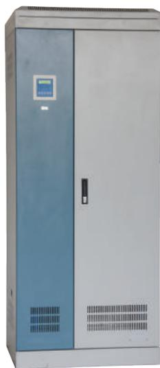
应急电源也称EPS，专门为消防设备和专用负荷或照明用电而设计。当电网电压正常时，电网交流电经本设备内互投装置直接给负载供电，同时本设备内充电器对电池组充电。当电网停电或电网电压低于15%或高于10%额定电压时，本设备将立即切换到逆变输出电源，由电池组备用电源经逆变器输出交流电，继续给负载提供电源。当电网电压正常后，本设备将恢复至电网供电。为适应消防应急时电源的需求，本设备设有手动启动应急逆变开关、电池组欠压保护强制解除开关。
