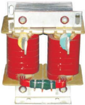
滤波电抗器，又称直流平波电抗器，用于变流器的直流侧，电抗器中流过的是具有交流分量的直流电流。它的作用是将叠加在直流电流上的交流分量限制在某一规定值内。还用于并联变频器的直流侧对耦，降低断续极限，限制环流线路中的环流，应用于直流快速开关切断故障电流时限制电流上升率，还被用在电流、电压型变频器中间回路的直流平波，这可用于整流电源平波，以消除纹波。
