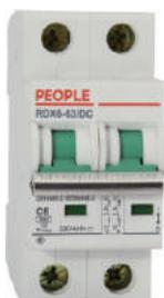
RDX6-63/DC直流小型断路器,主要用于直流电路,额定工作电压至440V,额定电流至63A,额定运行短路分断能力不超过6000A的保护配电路路中,作为线路不频繁接通、分断和转换之用,具有过载、短路保护功能。同时具有强大的辅助功能模块,如辅助触点、带报警指示触点、分励脱扣器、欠压脱扣器、远程脱扣控制等模块。
