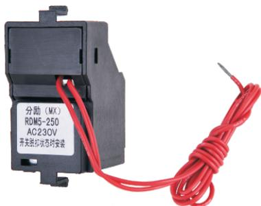
分励脱扣器是一种远距离操纵产品分闸的附件。当电源电压等于额定控制电源电压的70%-110%之间的任意电压时，分励脱扣器能可靠动作
