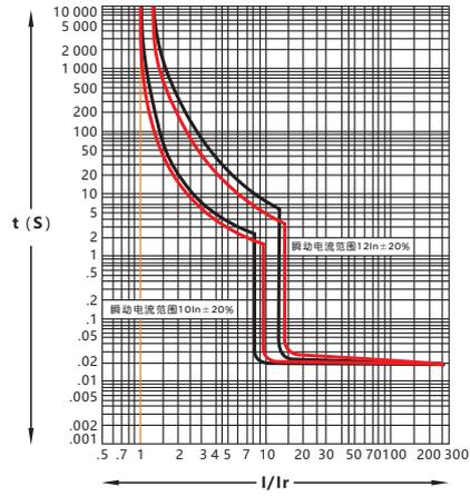
RDM5-630 配电保护(黑线)、电动机保护(红线)
