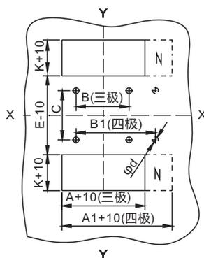
RDM5-125~800插入式板后接线安装板开孔尺寸
