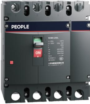
RDM5系列塑料外壳式断路器主要用于交流50Hz，额定绝缘电压1000V，额定工作电压690V及以下，额定电流至2000A以下的配电网中，用来分配电能和保护线路及电源设备免受过载、短路和欠电压等故障的损坏。其中额定电流630A及以下的断路器亦可作为保护电动机之用正常情况下，断路器可分别作为线路的不频繁转换及电动机的不频繁起动之用。断路器具有隔离功能，采用符号“ $\text{—} \text{I} \times \text{—}$ ”表示。产品符合：GB/T 14048.2，IEC 60947-2 标准。
