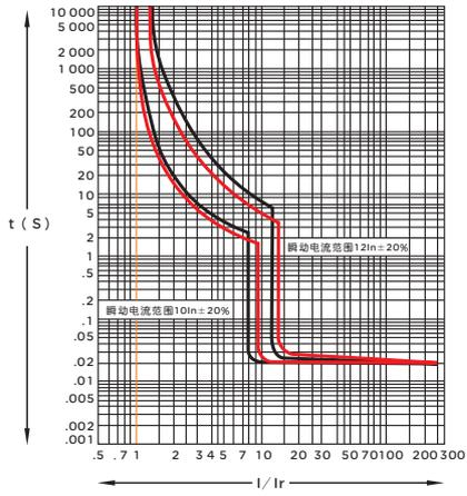
RDM5-400 配电保护(黑线)、电动机保护(红线)
