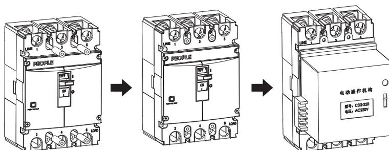
⚠ 带电操机构的断路器脱扣跳闸后，电操机构必须先分闸，然后才能合闸
