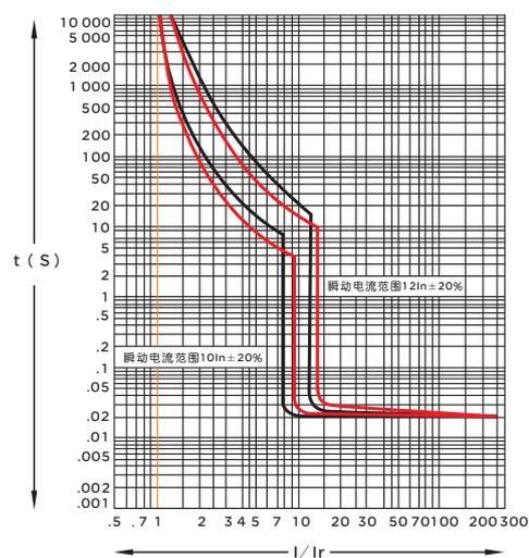
RDM5-63、125、160 40A-125A 配电保护(黑线)、电动机保护(红线) RDM5-250 配电保护(黑线)、电动机保护(红线)
