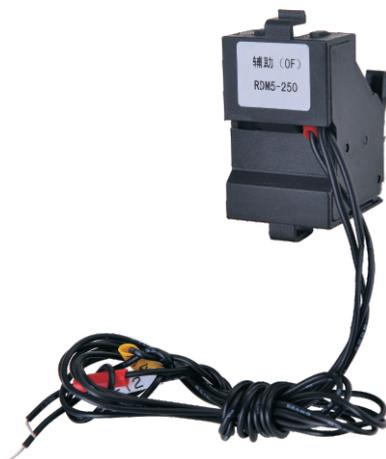
报警触头主要用于断路器的负载出现过载、短路或欠电压等故障或自由脱扣时提供信号，断路器处于分闸或合闸状态时，B12和B11接通，B14和B11断开；断路器处于脱扣状态时，B12和B11断开，B14和B11接通。
