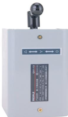
结构：QX1手动式星三角起动器主要由四个结构相似的触头元件和一个定位机构组成。四个触头元件的触头部分完全相同，是双断点形式的触头，其分合动作由不同外缘形状的凸轮控制。起动器有起动（Y）、停止（O）和运行（Δ）三个位置。
