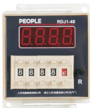
RDJ1-14计数器继电器，适用于交流50Hz/60Hz，额定电压380V/220/DC24V的控制电路中作计数元件，按预定的数字接通或分断电路。本产品主要应用于工业自动化控制系统，广泛应用于石油、化工、纺织、机械、矿山、国防、农业、食品、印刷等行业。本产品计数范围宽，具有 $\times 1 \times 10 \times 100$ 倍速率选择，计数准确，超强抗干扰，高可靠性，外形安装方便。产品符合：GB/T 14048.5和JB/T8794-1998标准。
