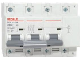
RDX2-125S分励脱扣断路器。该产品适用于交流 50Hz或60Hz, 额定工作电压230V/400V, 额定电流为125A及以下的控制线路中对线路进行远距离控制分断及自动信号控制分断, 同时对线路过载和短路的保护作用, 也可在正常情况下作为线路不频繁操作转换之用。目前广泛用于单相/三相智能预付费电能表(如IC卡)的配套使用, 以实现控制线路的通断。该系列产品具有分断能力高、体积小、重量轻、部件通用性强、外形美观等优点, 标准导轨安装, 使用方便。
