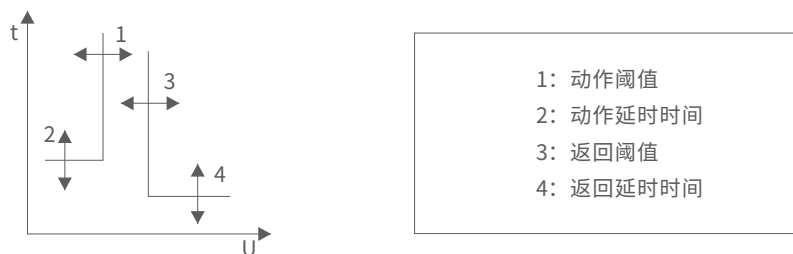
图1 欠压保护动作原则
