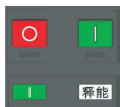
断路器合闸且无储能状态
