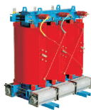
20KV级SC(B)10系列环氧树脂浇注干式变压器 额定容量：50~2500KVA 额定电压： 20 \pm 2 \times 2.5\% / 0.4 联结组别：Dyn11或Yyn0 额定频率：50HZ 冷却方式：ONAN
