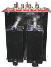
10KV级S11-MD系列地埋式油浸式配电变压器 额定容量：30~1600KVA 额定电压： 10 \pm 2 \times 2.5\% / 0.4 联结组别：Dyn11或Yyn0 额定频率：50HZ 冷却方式：ONAN
