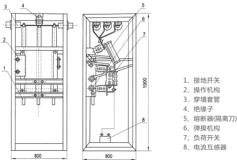
环网柜配用FN25-12型高压真空负荷开关，用真空开关开断故障与过载电流，其开关所组成的隔离开关、真空开关、接地开关、柜门之间按一定程序相互联锁，能有效地防止误操作；真空开关柜，配有电动弹簧储能操作机构可实现快速合分闸操作。并可根据用户要求，配装一定的保护继电器。熔断器组合电器柜，熔管带有撞针，短路情况下，撞针撞击跳闸机构，实现快速开断，能有效地保护电器设备。
