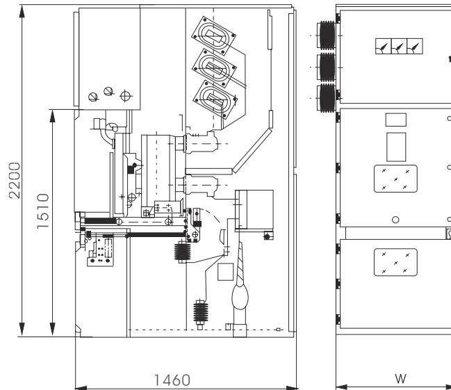
图 2 KYN28C 开关柜柜体结构
